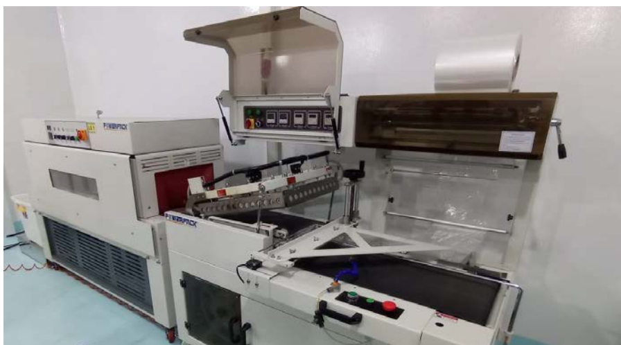
Mesin L-Shrink: Pengemas produk, membungkus box (yang berisi produk) dengan plastik POF Film, agar produk terhindar dari oksidasi dan polutan.
