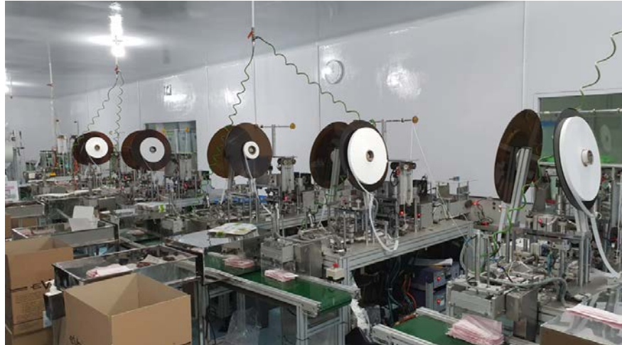
Mesin Tie On: Mesin untuk memasang tali ( tie on ) pada masker. Masker regular yang telah diproses mesin ini sudah siap untuk dikemas
