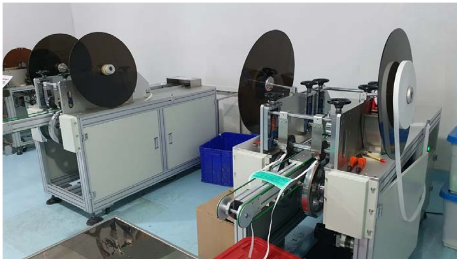
Mesin Tie On: Mesin untuk memasang tali ( tie on ) pada masker. Masker regular yang telah diproses mesin ini sudah siap untuk dikemas
